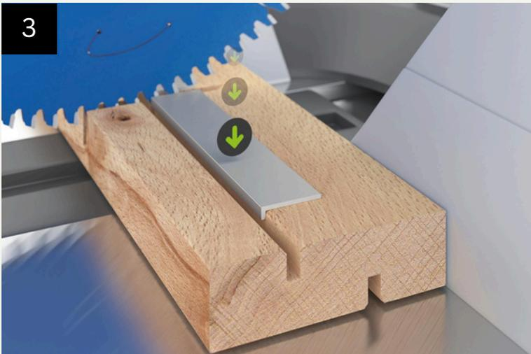
Die Profile werden passend abgelängt. Hierbei wird in einem Arbeitsgang der Gehrungsschnitt für Innen- oder Außenecke angebracht. Das Profil wird dabei sicher in unserer Schnitthilfe positioniert. Das Profil kann somit beim Schneidevorgang nicht verkanten.
